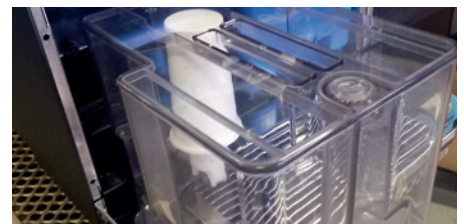
Wassertank: für den mobilen Einsatz der Maschine
